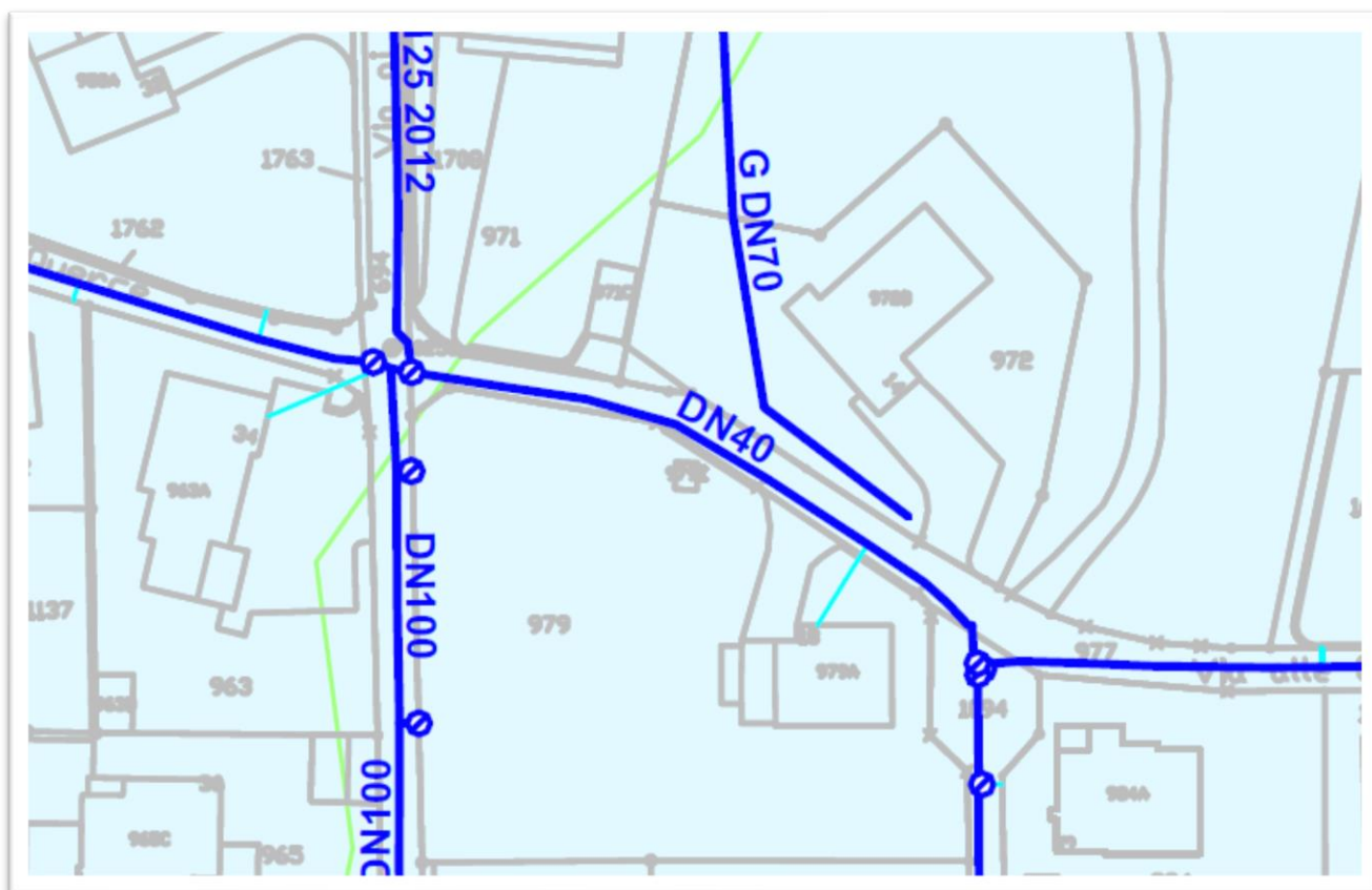
Figura 2: condotte acqua potabili stato di fatto (PGA 2014)
