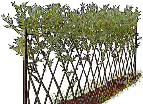
Palizzata viva di salice intrecciato
