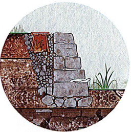
Muro in pietre a secco e cavità
